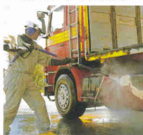
500bar/30l/min 清除旧的油漆垢层
