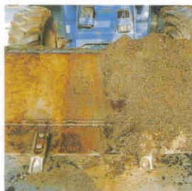
500bar/30l/min 高压热水清除干固的沥青
