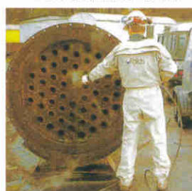
500~1500bar 工业换热器管路清洗
