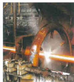
500bar/30~80l/min 冶金行业清除氧化层、铸造砂粒
