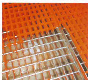
500bar/30l/min 清除隔栅上的油漆
